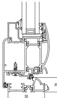
Seuil de 20 mm en conformité avec le DTU 36.5 et les directives du CSTB Design Softline pour l'exemple ci-dessus
